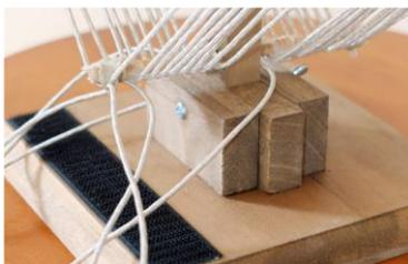
底板平板、支柱固定木材との間に支柱をはさみ込み前板同様、M4ネジと蝶ナットでとめました。支柱固定木材は奥側と左・右だけを底板平板に固定し、手前板は底板平板とは固定せず支柱をはさみこむために使いました。
