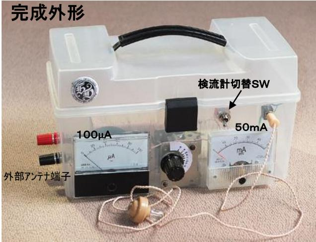
検流計としてホットスポット探検用の $100\mu\text{A}$ と、送信所近くなど、強電磁界テスト用の $50\text{mA}$ の2個の電流計を付けました。(切替SW付)
