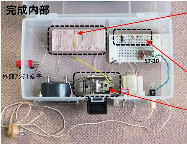
アンテナと1次同調側は $0.04 \times 300$ 、2次側は $0.04 \times 100$ のリッツ線を使い、汎用のEMIクランプ12個組み合わせコアとしてコイルを作成。
