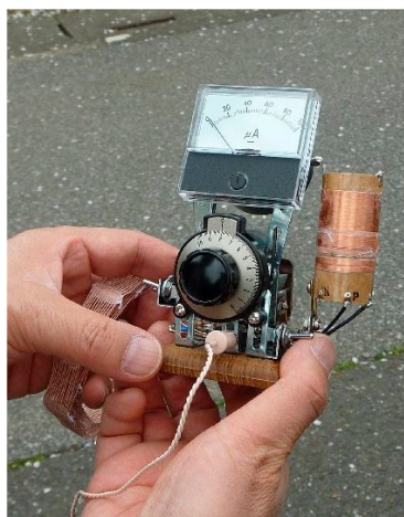
写真1 今村さん製作の多バンド型ゲルマラジオと、左手にはバスケット・コイルが…
