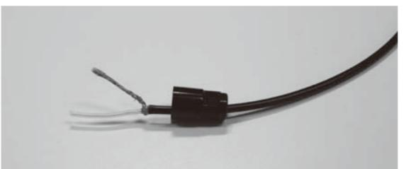
**4** 3で加工した1.5C-2Vの芯線と網線部分をフェライトロッドに巻いたポリウレタン線の両端にはんだ付け。ポリウレタン線は熱で被覆がはがれるので、そのままはんだゴテを当ててはんだ付けできます。
