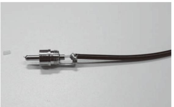
**5** はんだ付けが終わったら、ビニールテープではんだ付け部分を保護して、同軸ケーブルもフェライトロッドに沿わせてビニールテープで固定します。
