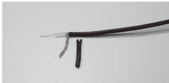
**7** 1.5C-2V同軸ケーブルの反対側にRCAピンプラグのカバーを差し込み、同軸を写真のように加工します。
