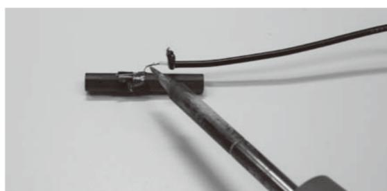
**8** RCAピンプラグと同軸ケーブルをはんだ付けします
